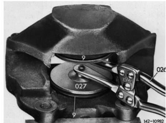
13 Wärmeabschirmblech (7) so in den Kolben einsetzen, daß die Ausparung im Blech genau in die Erhöhung des Kolbens paßt.
