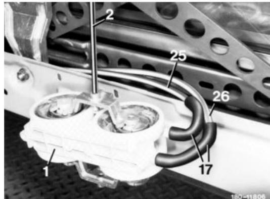
6 Sicherungsscheibe (43) der Schaltstange (2) am Unterdruckelement (1) abziehen und Schaltstange herausziehen.
