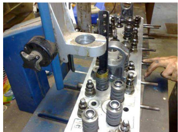
Ik heb een mooi ding gemaakt om de kleppen er uit en er in te zetten.
